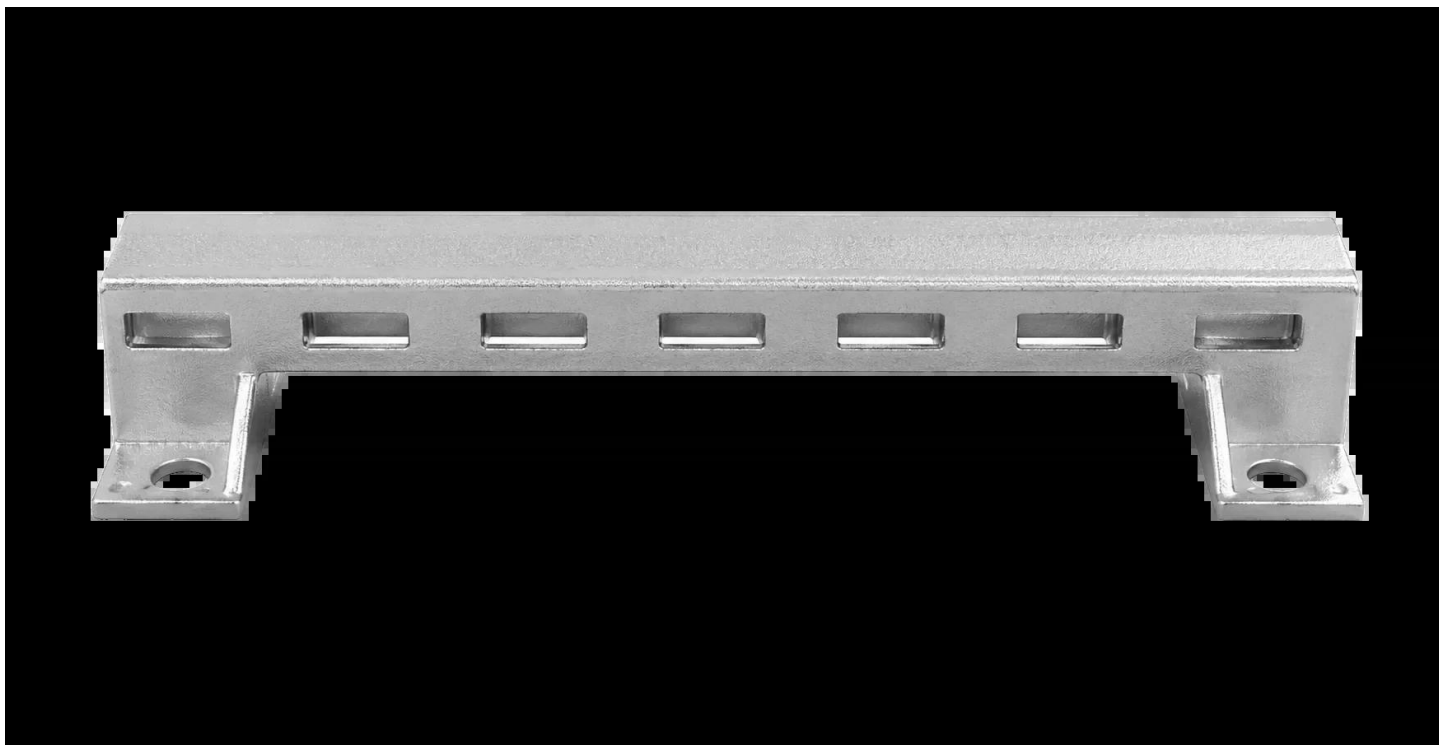
13. Portalträger Leichter und steifer Aluminiumträger zur Erhöhung der Dynamik und Schnittqualität.
