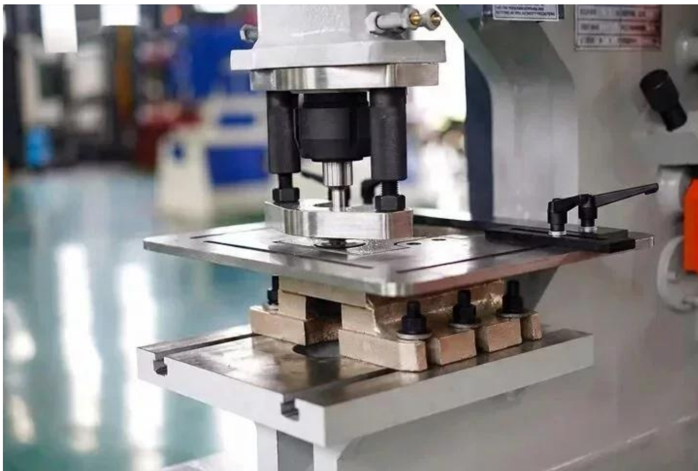
Lochstanzstation – Presskraft 90 Tonnen
