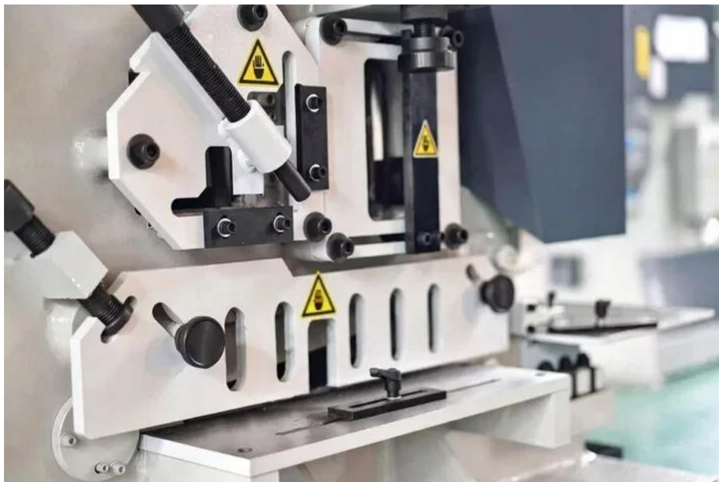
Schneiden von Winkelprofilen, Stäben und Stahlprofilen
