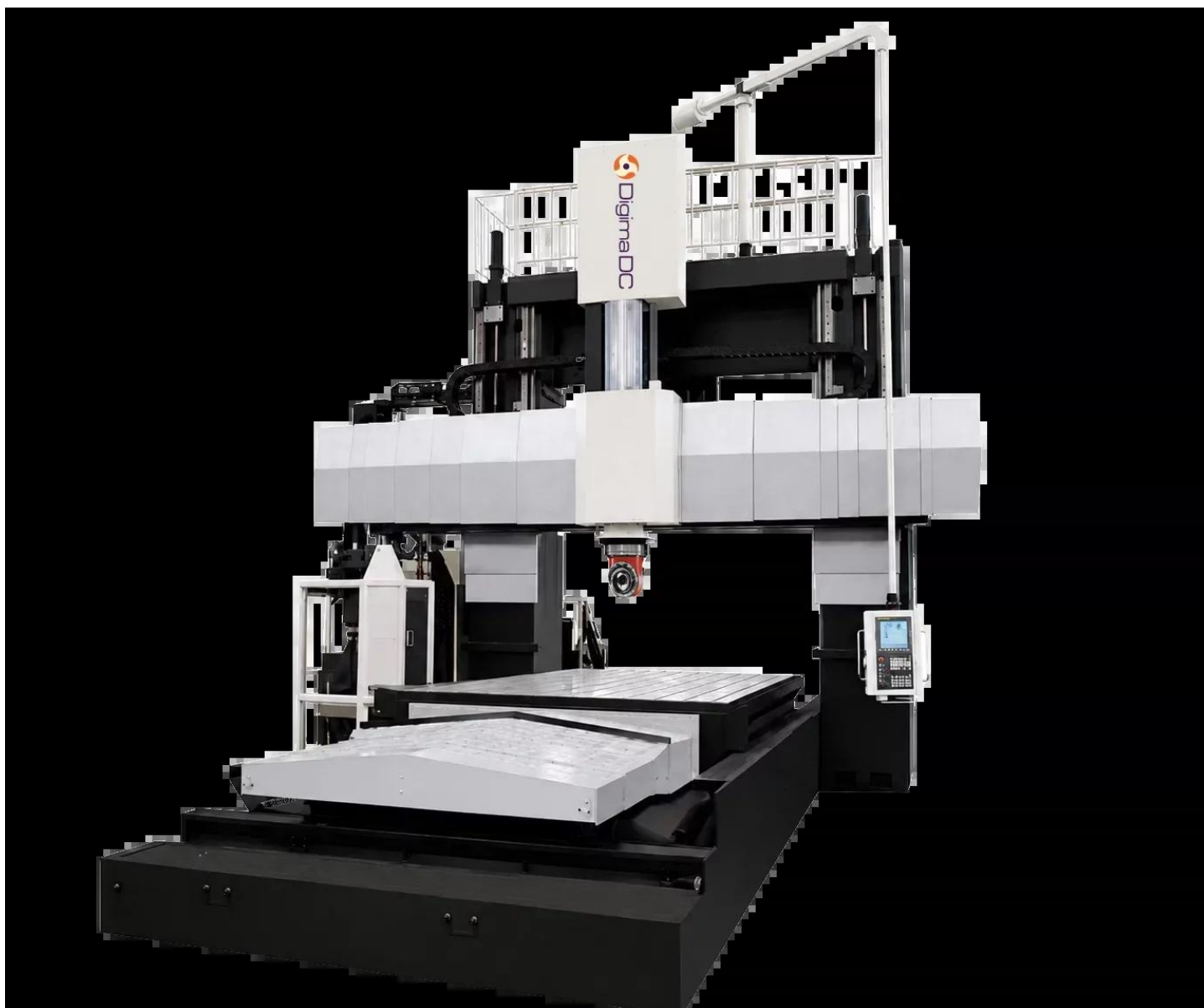
Zdjęcie główne modelu DM-1500W-CNC – centrum obróbcze bramowe CNC z osią W Centrum obróbcze bramowe CNC z osią W
