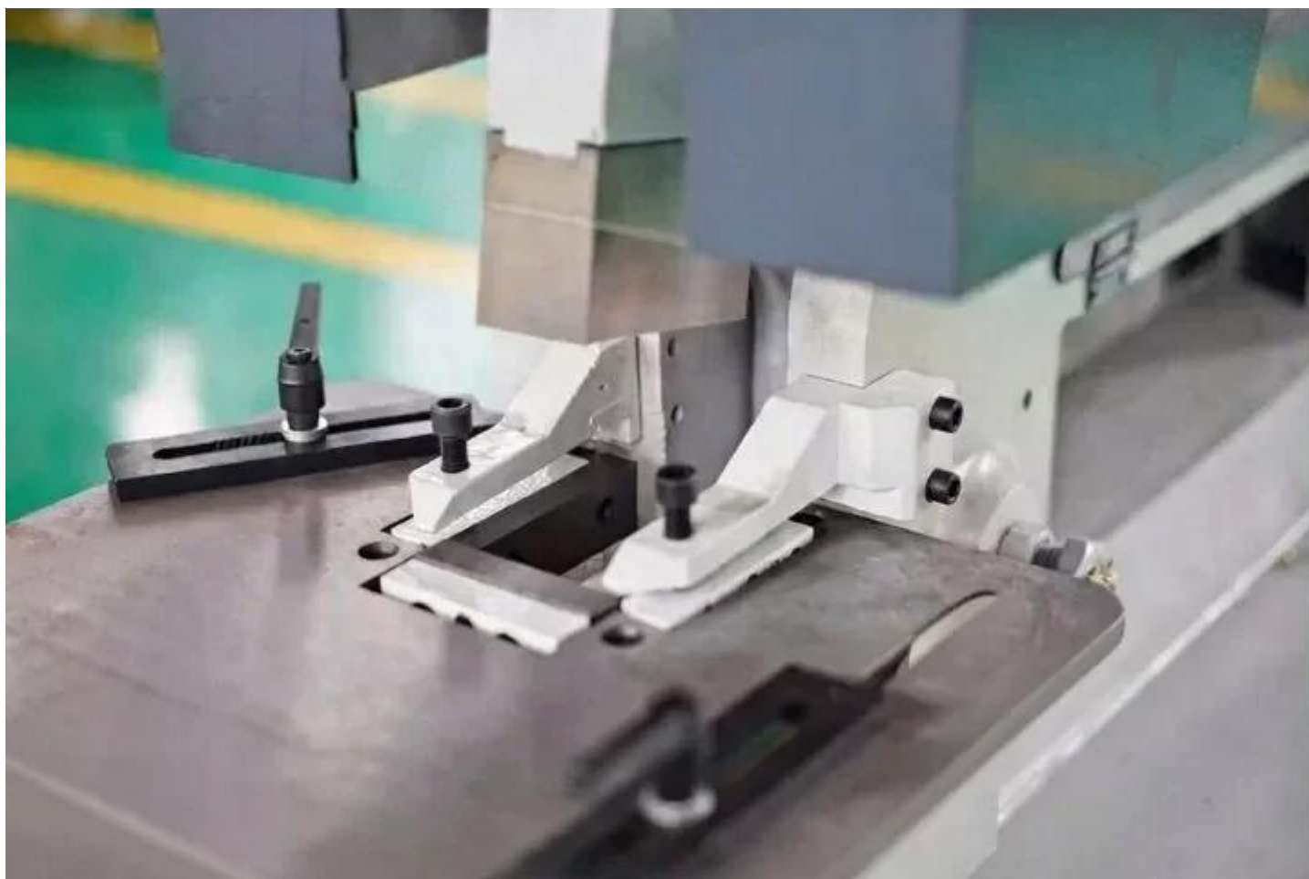
Hydrauliczne nożyce do blachy – cięcie materiału do 25 mm
