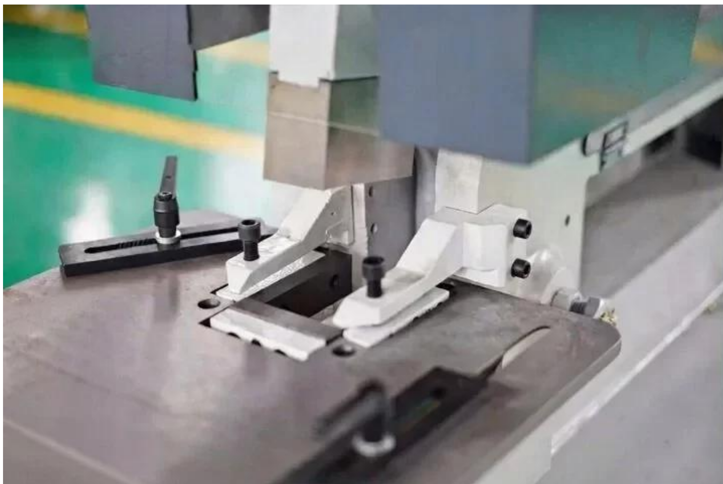
Hydrauliczne nożyce do blachy – cięcie materiału do 30 mm
