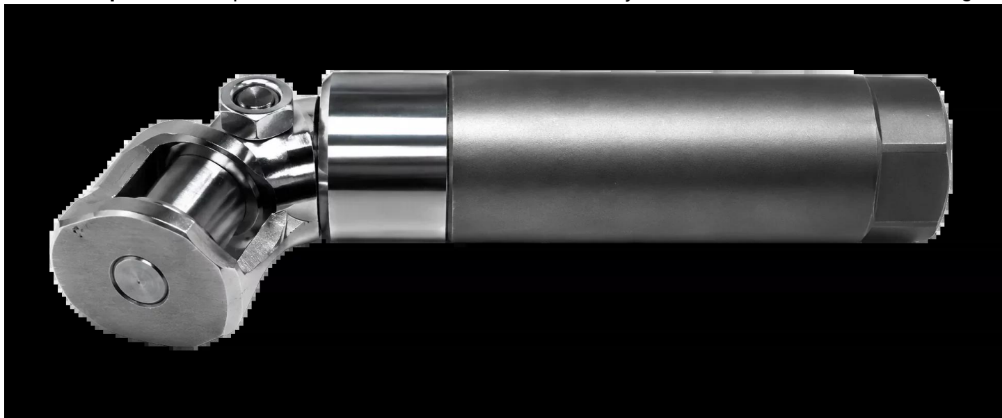
Mandrin en option Recommandé pour les petits rayons et les parois plus fines. Il aide à limiter la déformation de la section du tube.
