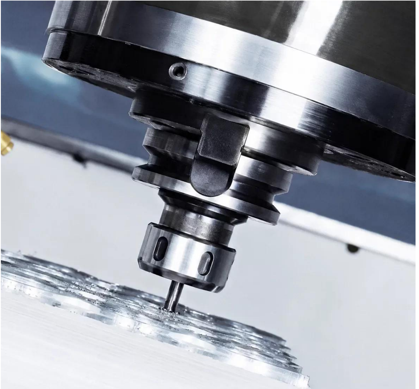
Broche Construction de la machine
