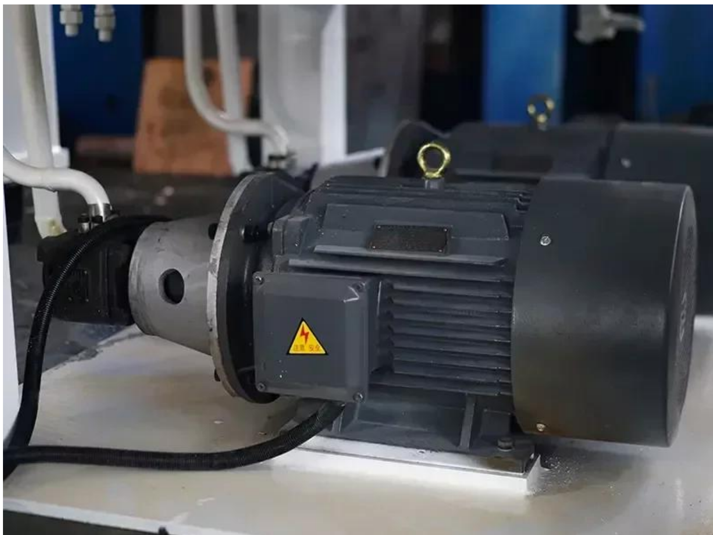
Silnik główny o mocy 18.5 kW
