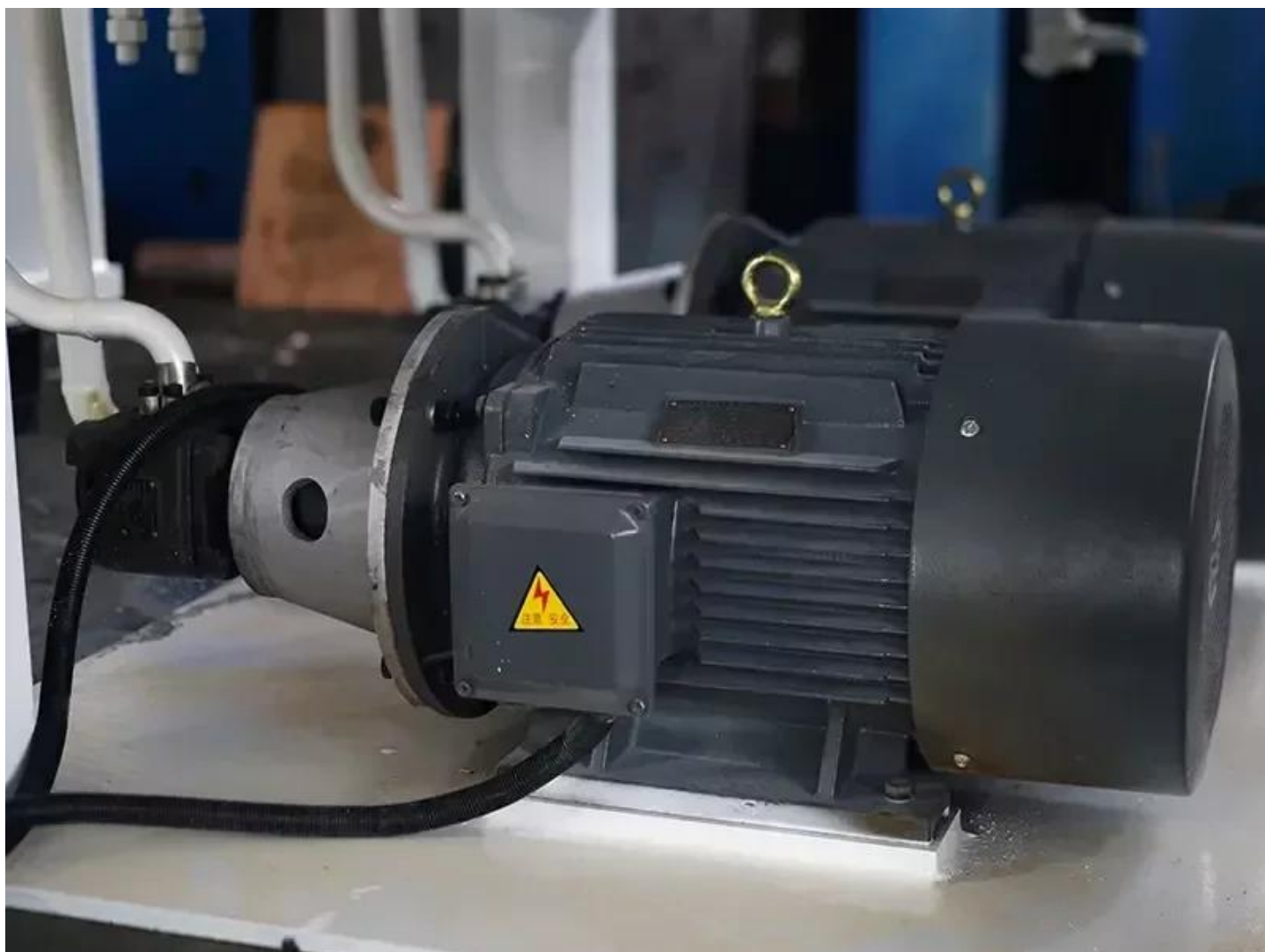
Silnik główny o mocy 7.5 kW
