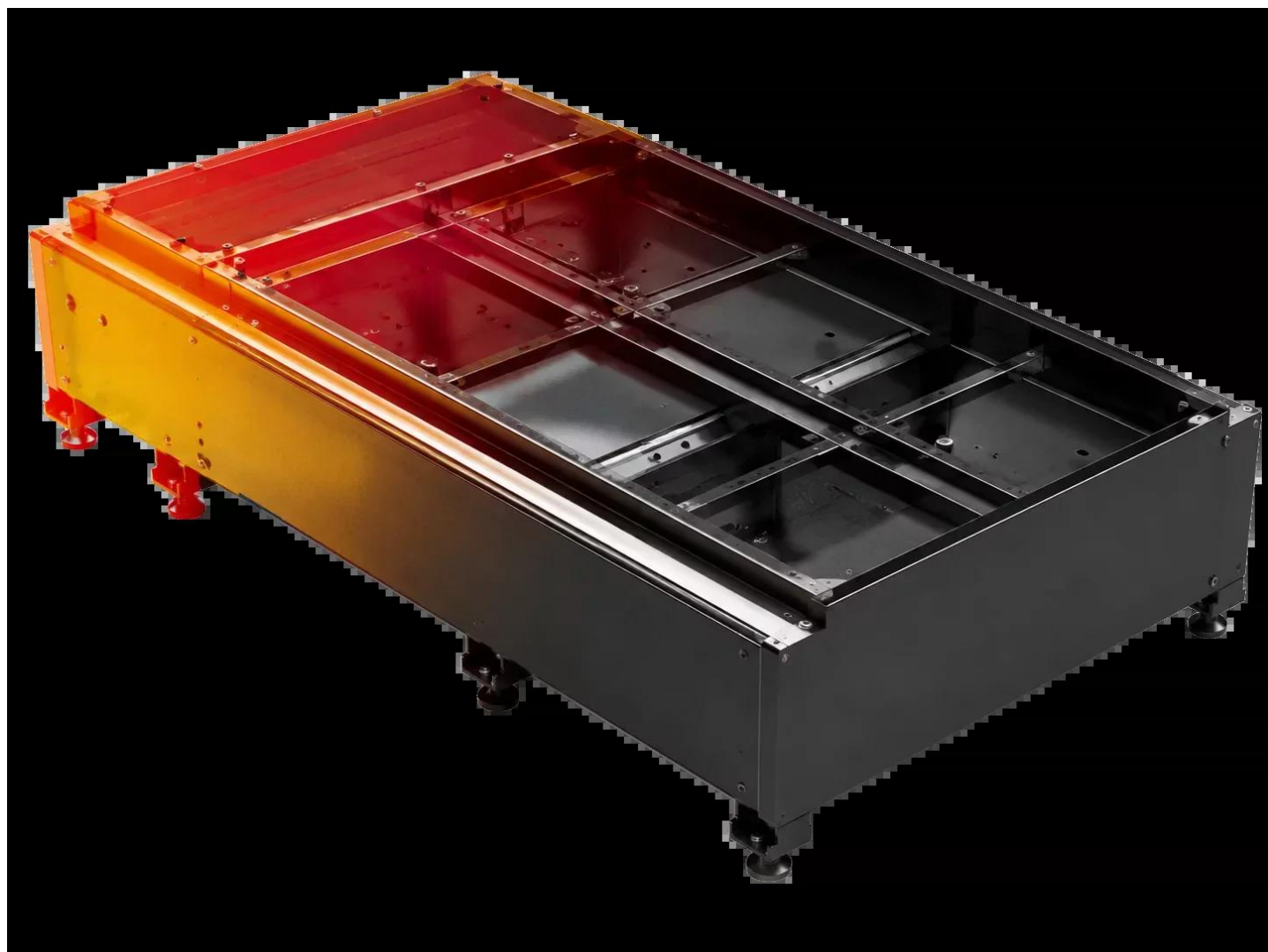
12. Łoże maszyny Łoże po obróbce cieplnej i procesie starzenia dla stabilności konstrukcji.
