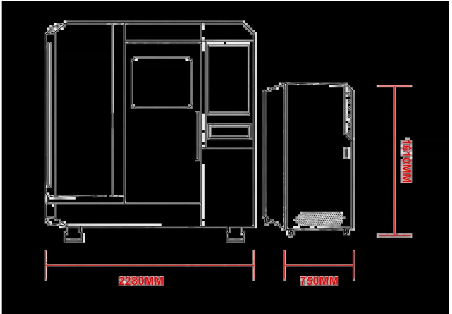
Rysunek wymiarowy maszyny Widok boczny oraz widok z góry z podstawowymi wymiarami konstrukcji DH-1520.
