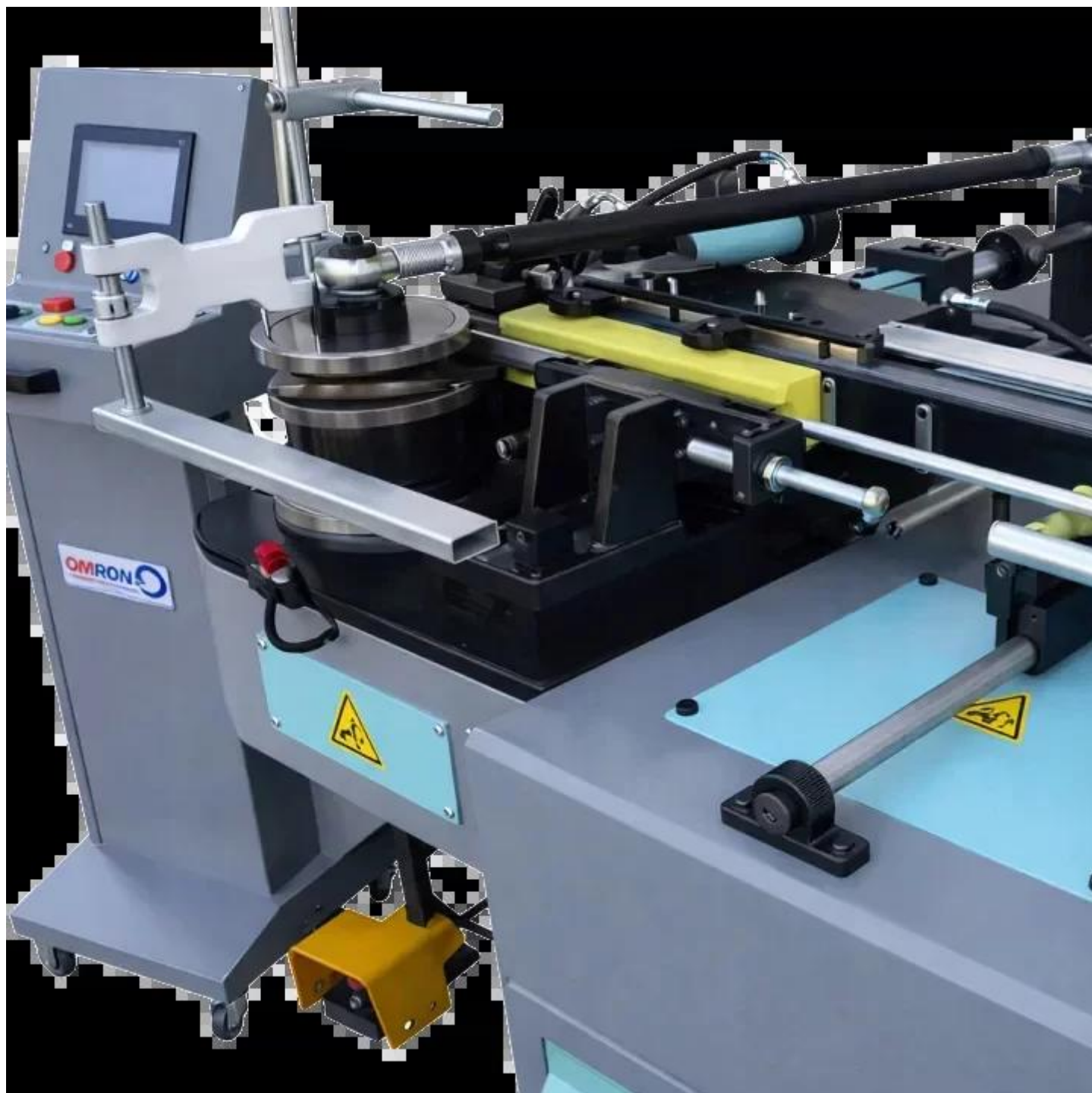
Widok maszyny CESURBEND PBNC-65 CNC Servo Charakterystyka
